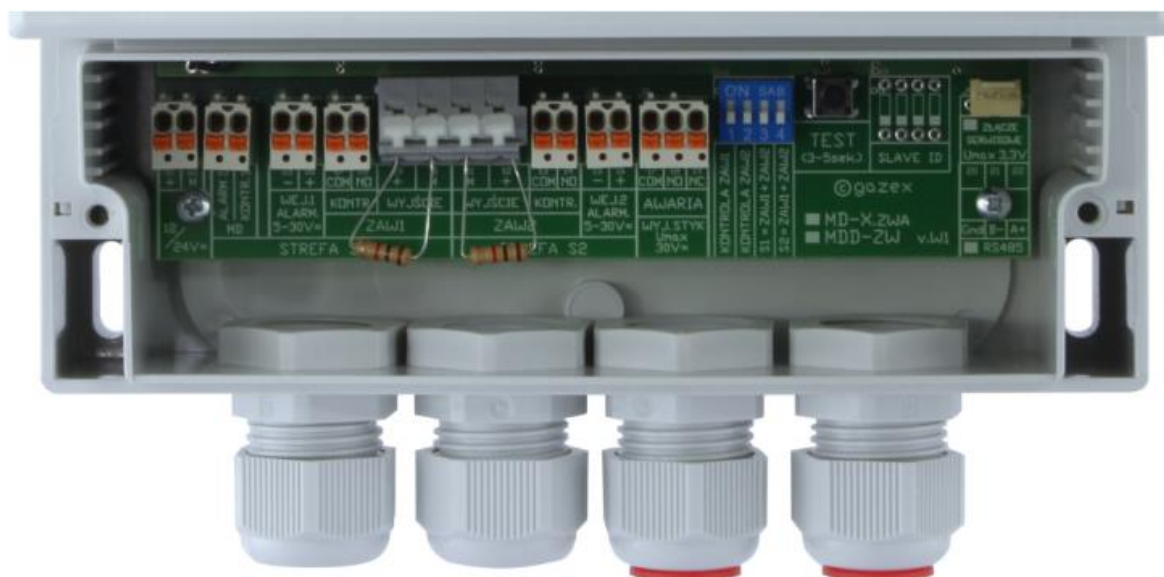
RYS.3.2. ROZMIESZCZENIE ZACISKÓW WEJŚĆ / WYJŚĆ NA PŁYCE GŁÓWNEJ, WIDOK PO OTWARCIU KOMORY ZACISKOWEJ MDX (dostępnych tylko podczas prac instalacyjnych).
