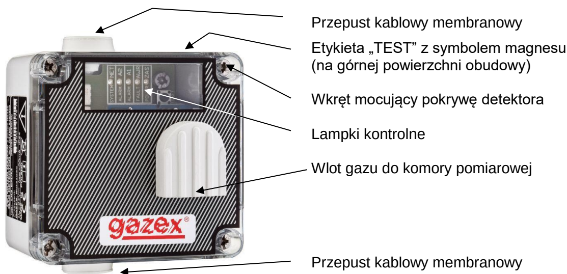
Rys.1.1. Widok DG.EN/M w zalecanej pozycji montażowej.
