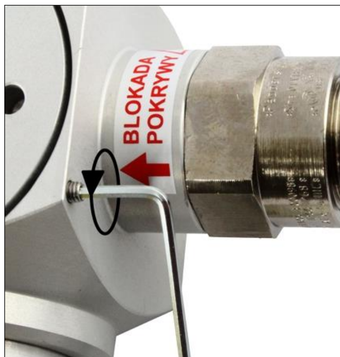
Rys.3.3. PRZED odkręcaniem pokrywy ==> odkręcić wkręt BLOKADY:
